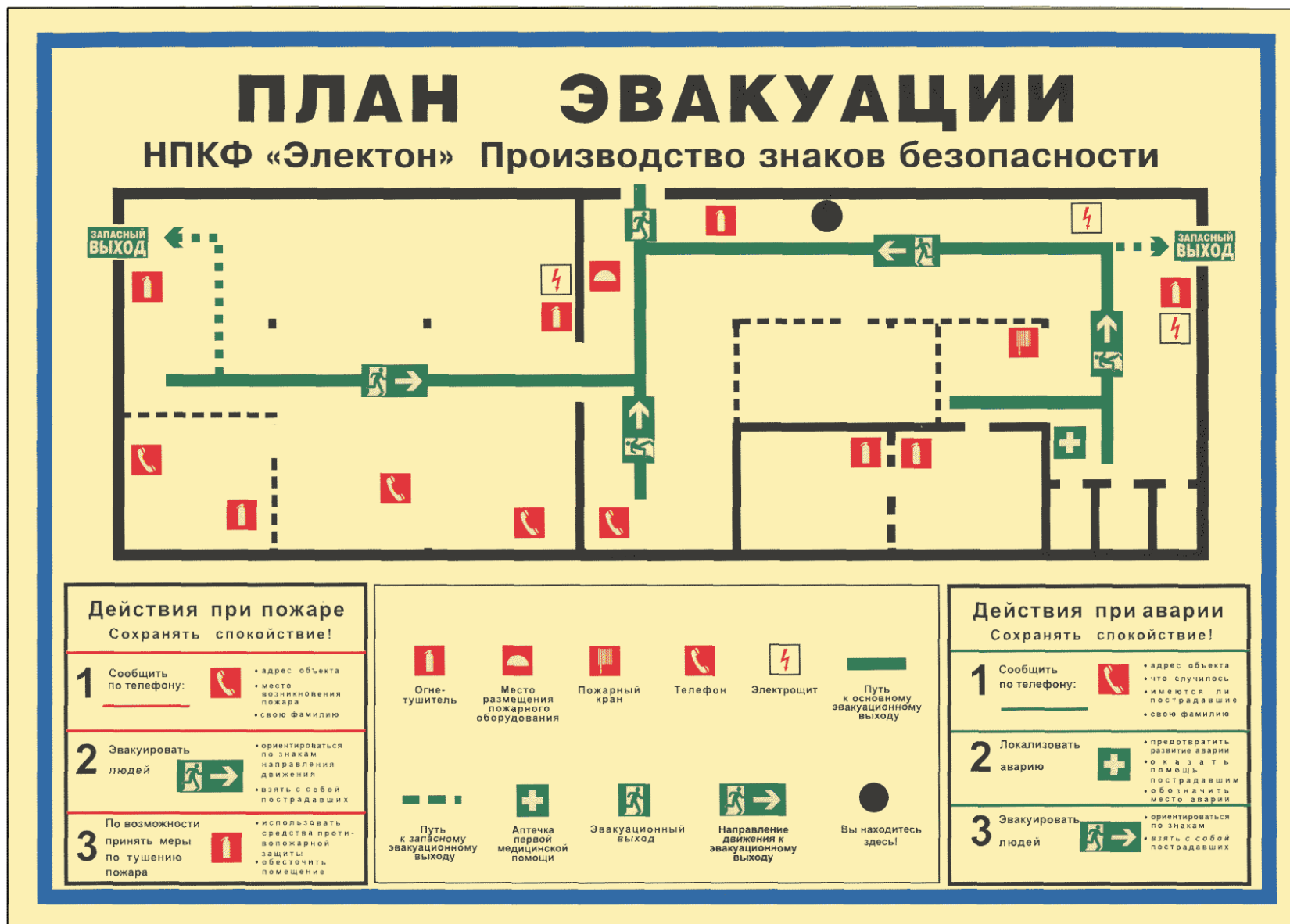
Рисунок В.2 - Секционный план эвакуации (фотолюминесцентный)
